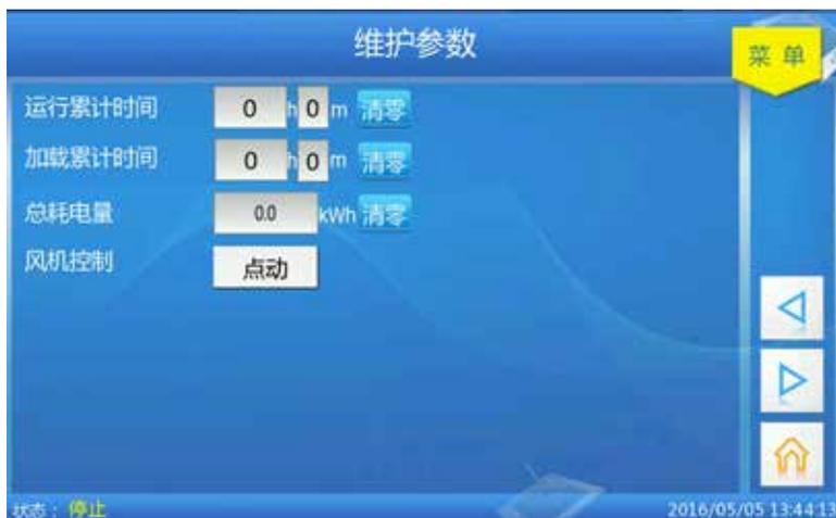
6. 主机点动试运行：在主页面点击启动按钮启动后，点击停止按钮。或者点击变频器面板上的 HAND 键和 OFF 键进行点动，观察主机转向。如果主机反转，请更改主机三相线序。
