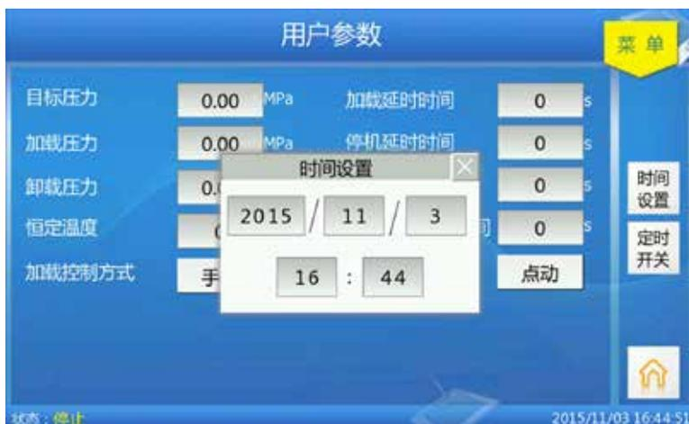
点击 **定时开关** 按钮，可以设置定时开关机功能。用户可以通过此功能实现自动起停的需求。
