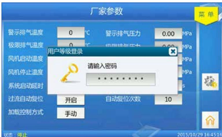
输入正确用户密码后，页面将出现密码管理图标
