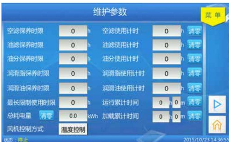
如需修改维护参数，页面会提示输入密码，需输入维护密码才能进行修改。
