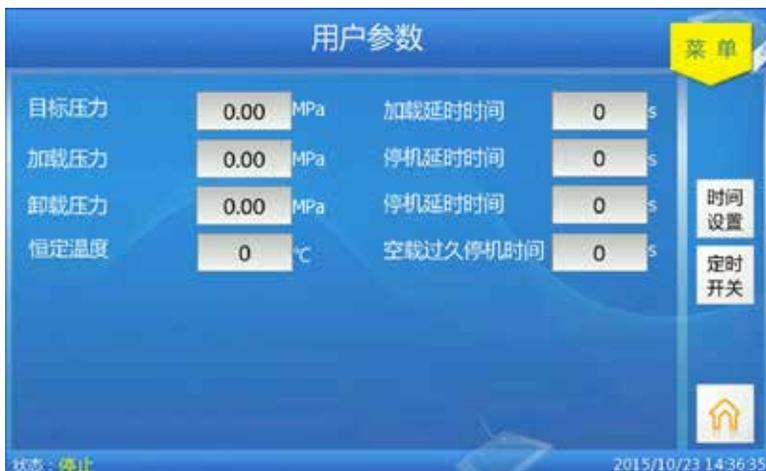
用户参数界面：用户可设置空压机实际的工况的参数，使空压机运行在最佳状态。修改用户参数时，会弹出密码窗口，必须输入用户密码。
