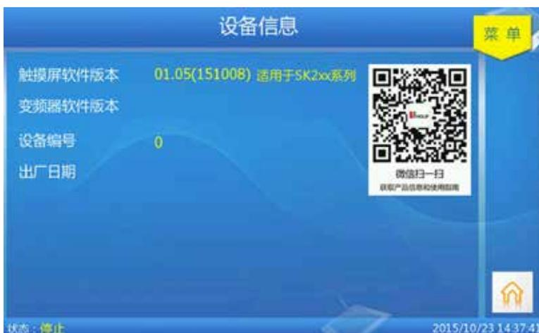
在设备信息界面中用户可以查看机器相关信息，并且通过扫描屏幕上方的二维码获取我们的产品信息和使用指南。空压机厂家可以通过密码解锁，在此界面上输入设备相关信息。
