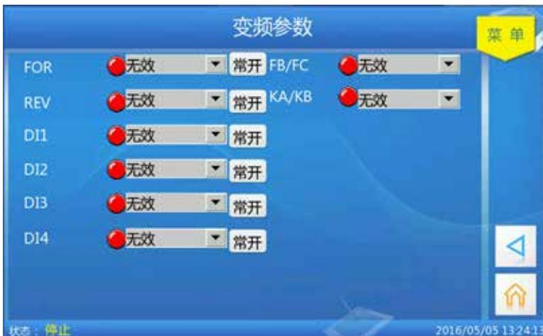
5. 在以下界面进行风机点动试运行，观察风机转向，如果风机反相，请更改风机电机三相线序。
