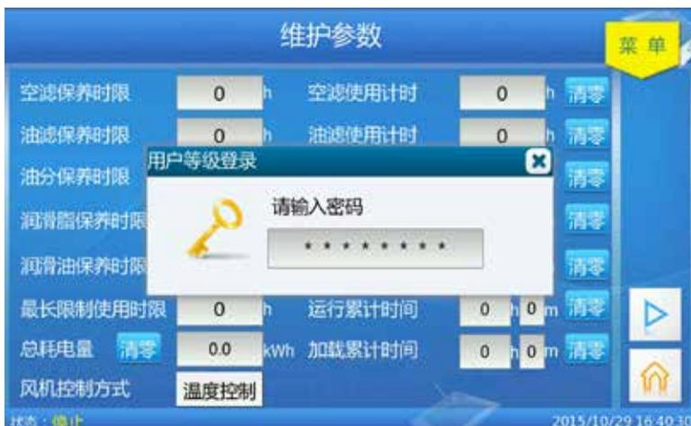
输入正确用户密码后，页面将出现密码管理图标
